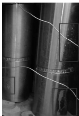
Рис. 3. Вид деталей после ионного азотирования: а – партия деталей №1; б – партия деталей №2
