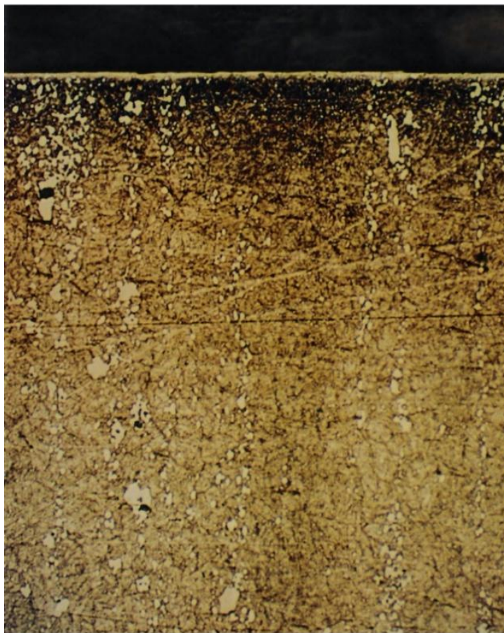
Рис. 4 Микроструктура образца из стали P18 после азотирования в газовой плазме вакуумно-дугового разряда в атмосфере чистого азота ( \times 800 ).
