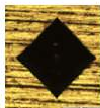
Рисунок 4 – Типовой отпечаток хрупкости, HV30, x100
